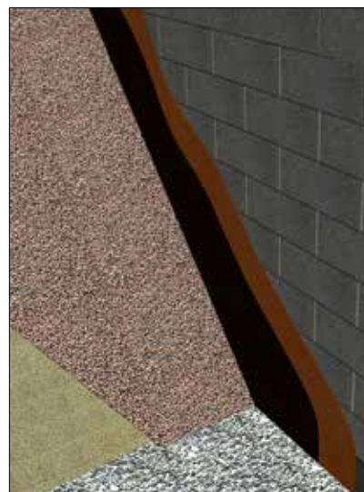
Bild 2.6 Källarvägg med LECA lättklinker
