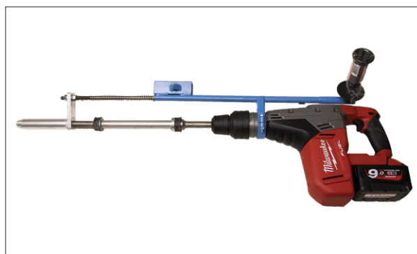
Monteringsbild 4. Nu är det klart att börja spika fast dina spikade kantstöd.
