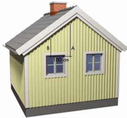
Bilde 1. Mål A minus mål B gir grunnlaget for beregning av husets takvinkel.
