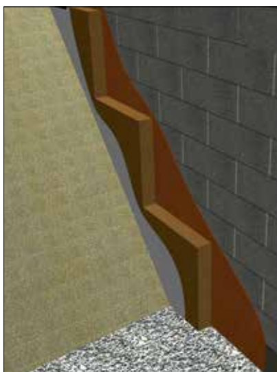
Bild 4.4 Källarvägg med Isodrän
