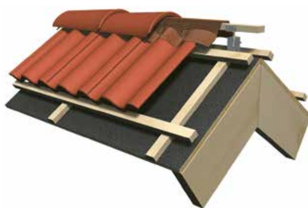
13 pav. Kraigo čerpės turi pasidėti ant medinio kraigo tašelio ir tuo pačiu remtis į eilines čerpes.
