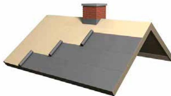
3 pav. Stogo plėvelė pradedama kloti nuo stogo apačios(karnizo) iki kraigo horizontalia kryptimi ir tvirtinama ventiliaciniais
