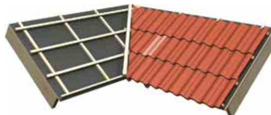
28 pav. Stoglatakių vietose naudokite ir pusines čerpes, nes pjau- nant mažus gabaliukus iš pilnos čerpės, juos gana sunku prit- virtinti. Pusinė čerpė paryškinta paveikslėlyje. Norimas nupjauti čerpes pažymėkite ant stogo, bet pjaukite jas pasidėję ant žemės. Iš karto po pjovimo nuplaukite čerpes po tekančiu vandeniu!
