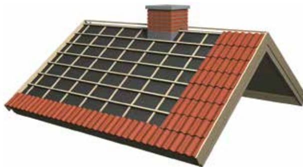
23 pav. Pradėkite kloti čerpes iš dešinės į kairę pusę, išdėliodami visą apatinę čerpių eilę (arčiausiai karnizo). Toliau iš dešinės pusės dėkite po dvi ar tris čerpes vieną ant kitos link kraigo. Įsitikinkite, kad eilės tiesios.
