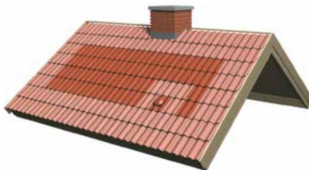
25 pav. Pritvirtinkite visas paryškintas čerpes.
