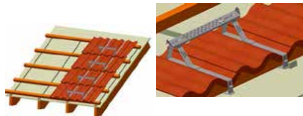
33 pav. Stogo kopetėlės montuojamos ant to paties grebėsto kaip ir stogo čerpės, užkabinant ją už grebėsto.
