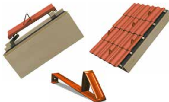
30a pav. Norint išvengti čerpių pažeidimo prie stoglatakių dėl slenkančio sniego, sumontuokite sniego „peilius“. (naudokite 3-4vnt/m 2 ).
