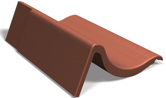
Der Giebelstein links 110 mm Einfach-S dient zur regen-sicheren, passgenauen und fachgerechten Abdeckung der Dachlinie linker Giebel/Ortgang an Gebäuden. Bei Einhaltung der Benders Verlegeanleitung und der Fachregel des Deutschen Dachdeckerhandwerks gilt der Formstein als regensicher und es wird eine Garantie von 30 Jahren auf Wasserundurchlässigkeit, Frostbeständigkeit und Druckfestigkeit übernommen.
